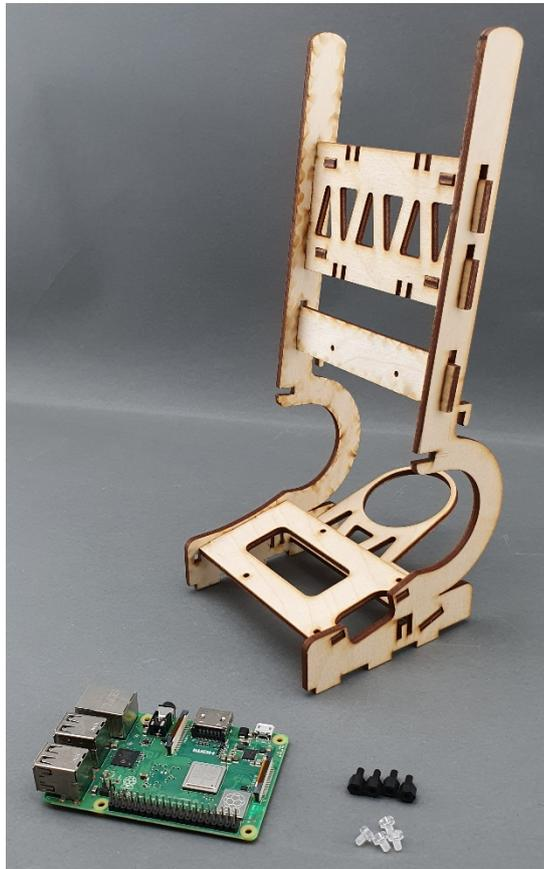
**Etapa 2: Colocar os parafusos de fixação na base para o Raspberry Pi, como nas imagens abaixo:**
